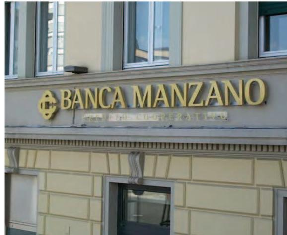
DESCRIZIONE: esempio di insegna a rilievo con caratteri autoportanti e simboli in metallo/ottone, retroilluminati.
