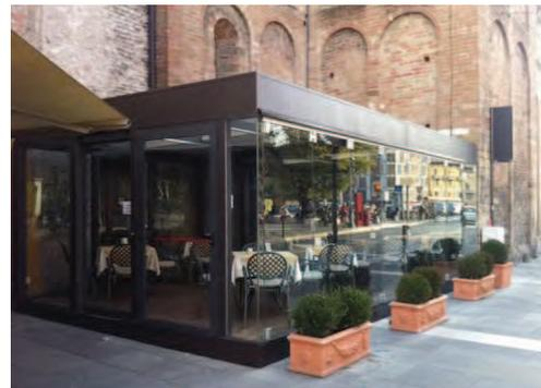
DESCRIZIONE: dehor con parete in aderenza alla relativa attività commerciale. Modulo a pianta rettangolare realizzato con struttura in metallo colore marrone e tamponature in vetro trasparente; copertura piana. La struttura è rialzata su pedana in legno.
