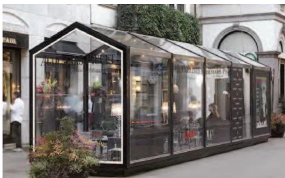
DESCRIZIONE: dehor con parete in aderenza alla relativa attività commerciale. Modulo a pianta rettangolare realizzato con struttura in metallo colore marrone e tamponature in vetro trasparente; c. La struttura è rialzata su pedana in legno.
