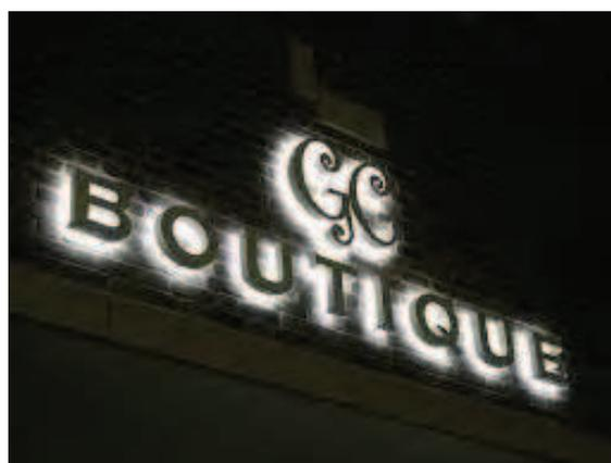
DESCRIZIONE: Esempi d'insegna a pannello installate a parete. Le insegne sono in metallo verniciato o corten con caratteri della scritta eseguiti a traforo e retroilluminati.
